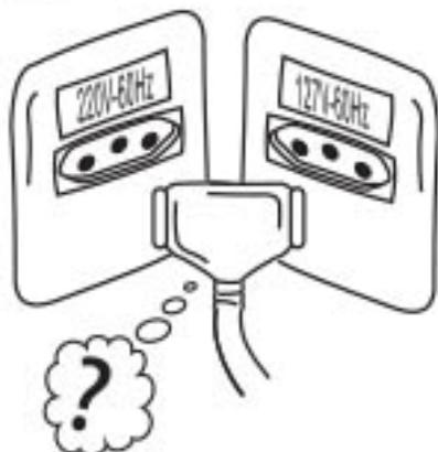
Verifique se o ponto elétrico é compatível com a voltagem especificada na etiqueta de identificação do equipamento. Coloque o plug na tomada.
