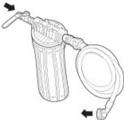
Uma vez encontrado o local correto, instale o filtro, se precisar consulte o manual de instruções. Drene pelo menos 14 litros de água para eliminar pó de carvão. Conecte a mangueira à válvula solenóide de entrada d'água. Seu equipamento foi fornecido com elemento filtrante com carvão ativado que deverá ser substituído pelo mesmo modelo ou similar para minimizar o efeito corrosivo do cloro sobre o aço inoxidável e garantir melhor qualidade do gelo produzido.
