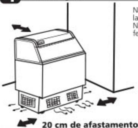
Nossos equipamentos necessitam de 20 cm nas laterais e traseira para perfeita circulação do ar. Não instalar o equipamento em ambientes fechados.
